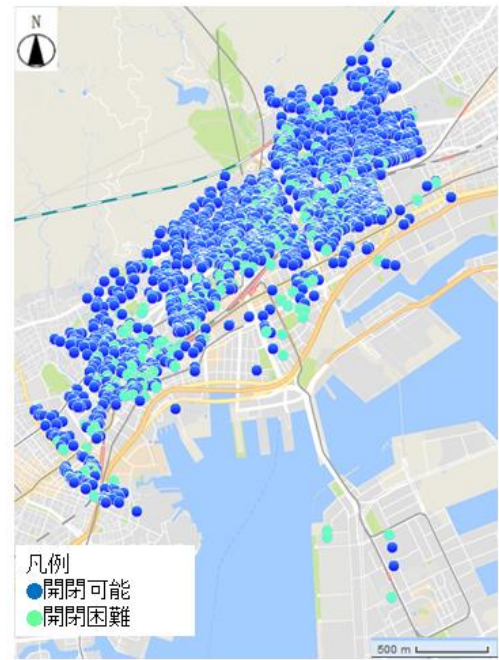
図 5 ドアの損傷分布図
